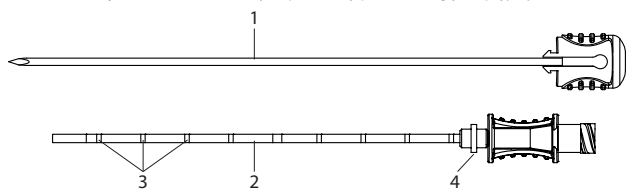
Rysunek 3: Standardowy współosiowy przewodnik igły biopsyjnej.
