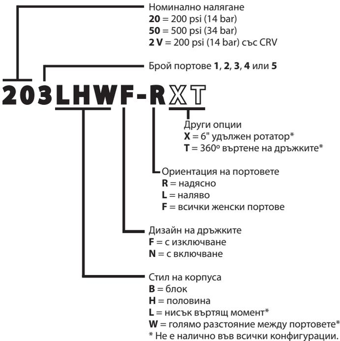
Колекторите DeVos на Merit са стандартни колектори с обратен предпазен клапан като краен порт. Колекторите DeVos се предлагат с:
