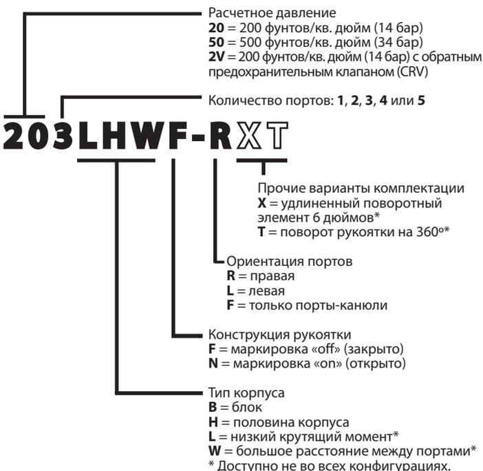
Коллекторы Merit DeVos представляют собой стандартные коллекторы с обратным предохранительным клапаном в качестве концевой отверстия. Поставляются коллекторы DeVos следующих конфигураций:
